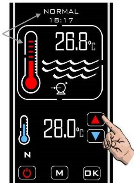
En la parte superior de la pantalla, se mostrará la temperatura actual del agua de la piscina. En la parte inferior de la pantalla, se mostrará la temperatura actual del agua de la piscina. La temperatura del agua que se requiera puede ajustarse con los botones táctiles «**UP / DOWN**» (**Arriba / abajo**) hasta que se muestre la temperatura requerida. Los ajustes son en incrementos de 0,1 °C.
