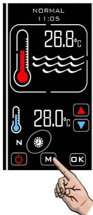
En este modo, el calentador solo calentará durante el periodo de encendido y si recibe suficiente flujo.
