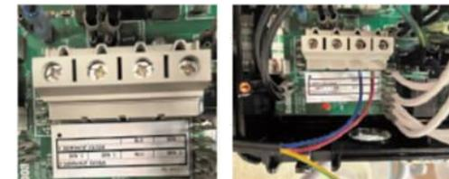
Una vez abierta la tapa del panel de control, localizaremos la clema de conexiones para realizar el conexionado de la alimentación según sea a 230V II o 400V III.
