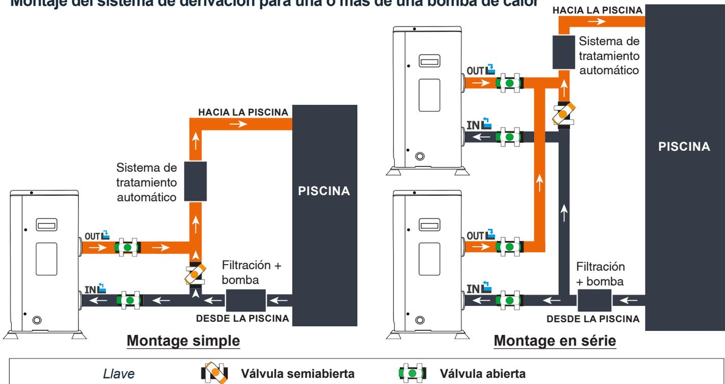
El filtro ubicado antes de la bomba de calor debe limpiarse regularmente para que el agua del sistema esté limpia y evitar de este modo problemas de funcionamiento derivados de la suciedad o el atascamiento del filtro.
