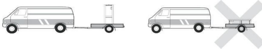
El equipo debe almacenarse y transportarse en todo momento en posición vertical sobre un palé, y en su embalaje original. En caso de guardarse o transportarse en posición horizontal, espere un mínimo de 24 horas antes de encenderlo.
