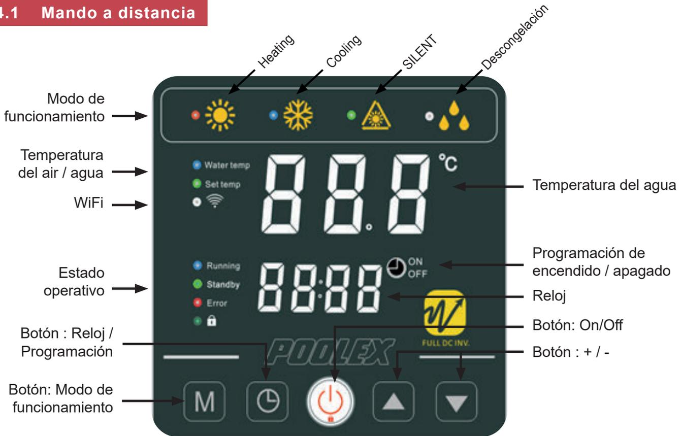
El mando a distancia vuelve automáticamente a la pantalla principal al cabo de 10 segundos
