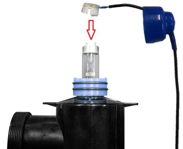
**NOTA:** *apriete el velo de sujeción azul de la lámpara cuando vuelva a montar la unidad para eliminar el aire atrapado. De no hacerlo, el aire atrapado puede provocar que la sujeción de la lámpara se desconecte de su extremo. Abra el suministro de agua para comprobar que no hay fugas **antes** de reconectar el suministro eléctrico.*
