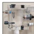
Sonda amperométrica para cloro libre
