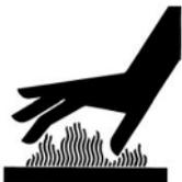
Las bombas que han funcionado en estas condiciones pueden acumular presión de vapor y contener agua muy caliente. Abrir la bomba puede provocar lesiones graves. Para evitar el riesgo de daños personales, compruebe que las válvulas de succión y de despresurización estén abiertas y que la cámara del prefiltro no esté caliente al tacto, después ábralo con extremo cuidado.
