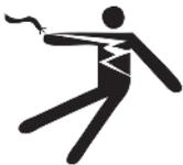
Antes de acometer cualquier tarea de mantenimiento en la bomba, desconecte siempre la bomba de la piscina de la toma de corriente usando el disyuntor. De no hacerlo, podría acabar provocando la muerte o heridas graves al personal de mantenimiento, a los usuarios de la piscina o a otros por descarga eléctrica. Lea todas las instrucciones de mantenimiento antes de intervenir en la bomba.
