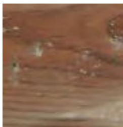
Surface mould/Moho superficial/ Moisissures superficielles/ Oberflächlicher Moder/Muf fa su- perficiale/Oppervlakte-schimmel/ Bolor superficial
