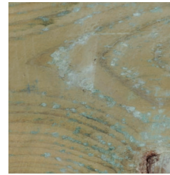
Retention of sterilization products Retención de productos de esterilización Rétention de produits détuve Rückstände von Sterilisationsprodukten Ritenzione di prodotti per la sterilizzazione Vasthouden van impregneringsmiddelen Retenção de produtos de esterilização
