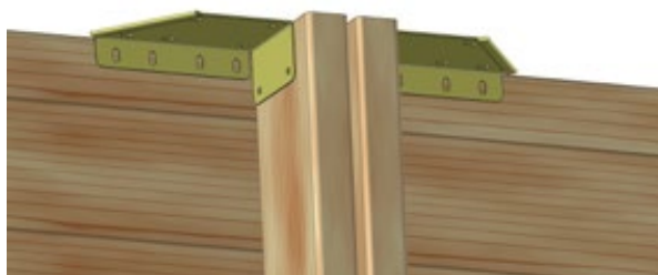
Figura 18 – Colocación de las escuadras de coronamiento en la parte superior de los puntales
