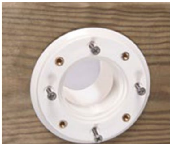
Figura 24 – Instalación del cuerpo de la boquilla de retorno y su junta
