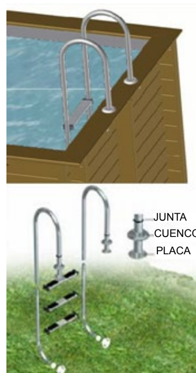
Figura 36 – Instalación de la escalerilla
