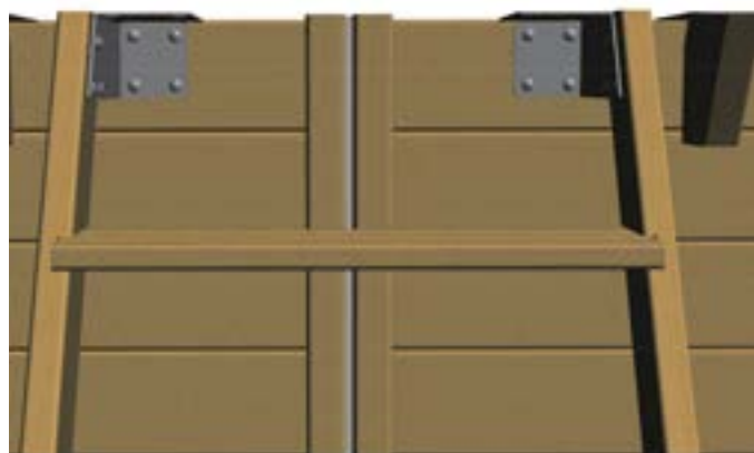
Figure 17 – Fijación de la escalera exterior sobre el vaso
