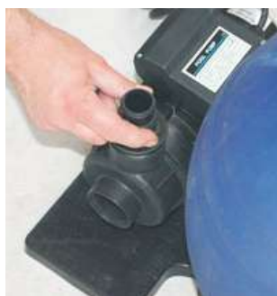
5 PONER LAS JUNTAS (10) EN LOS RACORD (9) APLICARLES TEFLON (15) EN LAS ROSCAS Y MONTARLOS EN LA BOMBA (1) Y EN LA VALVULA DEL FILTRO (4) BIEN APRETADOS PARA EVITAR PERDIDAS DE AGUA.
