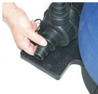
5 PONER LAS JUNTAS (10) EN LOS RACORD (9) APLICARLES TEFLON (15) EN LAS ROSCAS Y MONTARLOS EN LA BOMBA (1) Y EN LA VALVULA DEL FILTRO (4) BIEN APRETADOS PARA EVITAR PERDIDAS DE AGUA.
