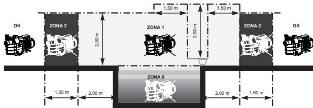
Installare la pompa in un locale ventilato e asciutto, poiché il motore richiede che l'aria circoli liberamente attorno ad essa, per consentirne la ventilazione naturale. Verificare regolarmente che il dispositivo di raffreddamento del motore non sia ostruito da oggetti, foglie o altri ingombri.
