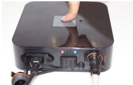
4.10 Presione el botón de encendido/apagado situado encima del transformador para arrancar el robot. Aparecerá una luz roja. Al final del ciclo de limpieza, la luz roja se apagará.
