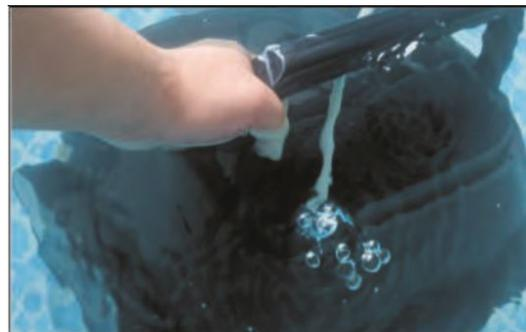
4.8 Coloque el robot en su piscina y espere hasta que esté totalmente sumergida. Si es necesario, ayúdelo a hundirse manualmente.
