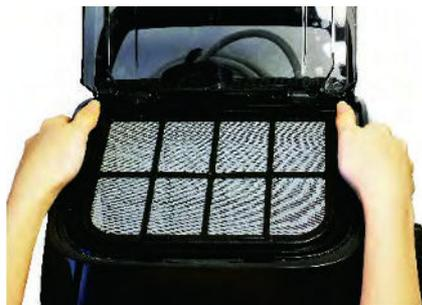
6.5 Una vez limpiado, vuelva a colocar la canasta en el robot. Si la canasta no está alineada correctamente, no es posible cerrar la tapa del limpiafondo.
