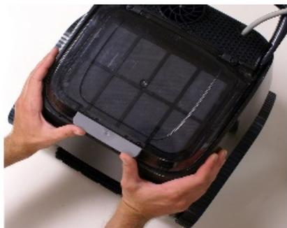
6.1 Para acceder a la canasta del filtro, coloque las manos como se muestra en la imagen. Empuje hacia arriba 5 cm con los pulgares para abrir la cubierta.
