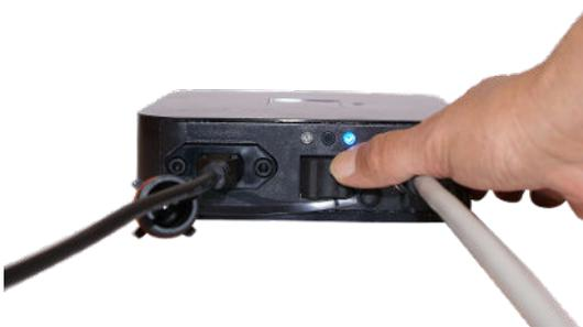
4.9 Presione el interruptor en el lado del transformador para encenderlo. Aparecerá una luz azul.
