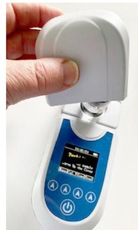
Utiliza **dos detectores a 90° y 180°** respectivamente. El detector de 180° recibe la luz transmitida y el detector de 90° recibe la luz dispersa. La intensidad de la luz dispersa y la luz transmitida se utiliza para calcular el valor de turbidez de la muestra.
