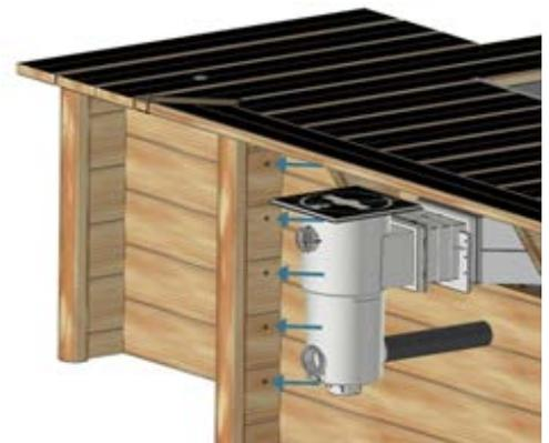
Figura 63 – Fijación del cofre sobre el vaso
