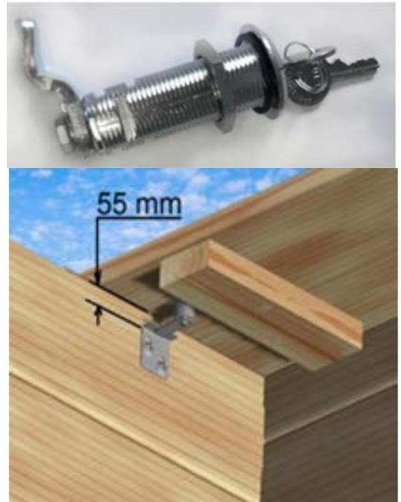
Figura 67 – Montaje de la cerradura
