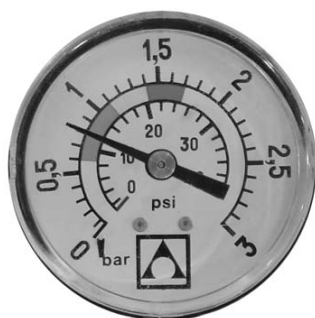
0,8 kg/cm 2 - 11,4 PSI: Pression normale au début du cycle de filtration.
