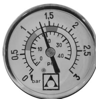
1,3 kg/cm 2 - 18,5 PSI: Esta presión indica que es necesario proceder al LAVADO
