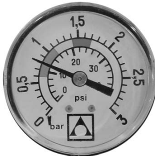
0,8 кг/см 2 - 11,4 PSI: Нормальное давление для начала фильтрационного цикла
