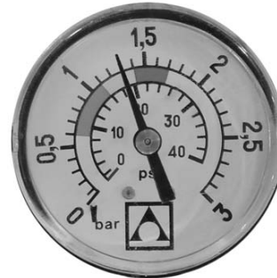
1,3 кг/см 2 - 18,5 PSI: Данное давление указывает на необходимость выполнения операции "ОБРАТНАЯ ПРОМЫВКА"
