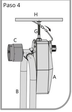
Paso 4: Conecte el cable de la parte H con el cable del motor y luego fije bien la tapa impermeable
