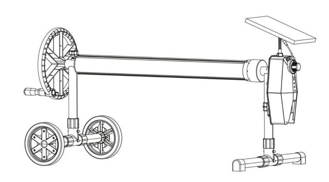
• NOTA: El motor debe ensamblarse en el lado opuesto del volante
