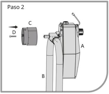
Paso 2: Tome la parte C y conéctela con la parte A, asegure el conjunto con el tornillo de metal D (tornillo M6)
