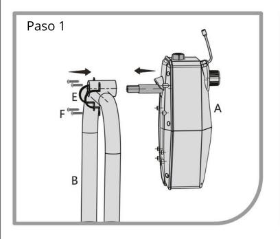
Paso 1: Tome la parte A e insértelo en el orificio de la parte B. Tome parte E y asegure el motor en el marco (parte B) con cuatro tornillos metálicos M5 (Parte F)
