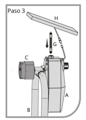
Paso 3: Tome parte G e insértelo en el orificio en la parte superior del motor. Y luego conecte la parte H (panel solar) con el otro extremo de la parte G
