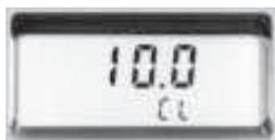
Introducir la solución calibradora de 10 NTU\*.
