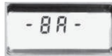
Indica "-BA-" cuando las pilas están prácticamente agotadas; el mensaje aparecerá unos segundos en pantalla y luego se apagará el equipo ; Ahora es necesario cambiar las pilas por unas nuevas. ( No tiene suficiente carga para poder encender el equipo )
