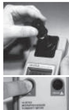
**NOTA:** En este punto, el usuario puede salvar la calibración en dos puntos pulsando el botón READ, saliendo del modo calibración.
