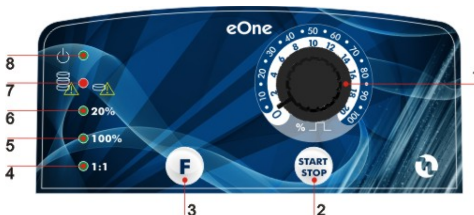
Fig.8 - tableau de commandes et signalisation
