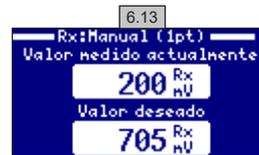
**6.13** Sin sacar la sonda del agua, fije con las teclas más/menos el ajuste de la lectura para coincida con su valor de referencia (fotómetro u otro medidor).
