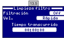
13.5 Limpieza de filtro: para la limpieza de filtro con bomba de velocidad variable, se recomienda utilizar la velocidad rápida.
