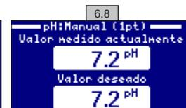
**6.8 Sin sacar la sonda del agua,** fije con las teclas más/menos el ajuste de la lectura para que coincida con el valor de referencia (fotómetro u otro medidor).
