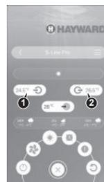
Es posible comprobar el ajuste visualizando las temperaturas de entrada/salida (1-2) directamente en la aplicación «EyesPool Inverter Connect» (ver párrafo 4.6).
