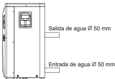
Instale una válvula "by-pass" entre la entrada y la salida de la bomba de calor.
