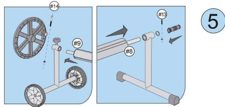
En un extremo de los tubos, introduce el soporte con ruedas dentro de la maraca (#9) y el volante, sujetándolo con el tornillo #14. En el otro extremo, introduce dentro de la maraca el segundo soporte y la pieza #7.
