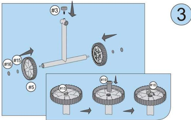
Introduce las ruedas en el soporte. Dentro de cada rueda, intruce la pieza #15, y con ayuda de la pieza #19, encaja el embel-lecedor (pieza #16) para que quede ajustado. La pieza # en la parte superior actúa de freno.
