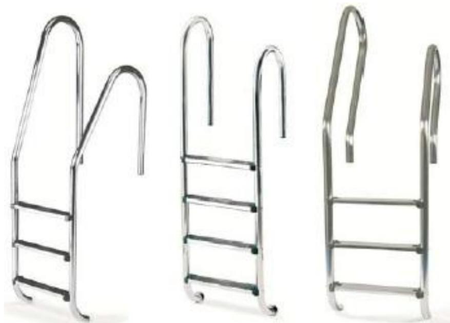
Escaleras fabricadas en tubo  $\varnothing$  43 mm de acero inoxidable AISI-304 o AISI-316 con acabado pulido brillante. Peldaños en acero inoxidable con superficie antideslizante. Su cuidado diseño garantiza seguridad contra todo tipo de deslizamiento o cortes.
