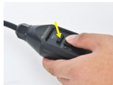
3. Drücken Sie die Test-Taste, die Anzeige erlischt.
