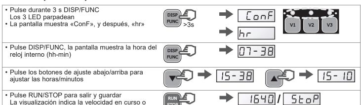
**Nota:** El ajuste del reloj interno es importante si la bomba funciona en modo **Timer**. Permanece guardado cuando la bomba se desconecta.
