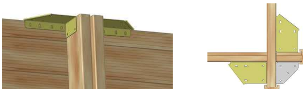
Figura 13 – Colocación de las escuadras de coronamiento en la parte superior de los puntales y en las esquinas
