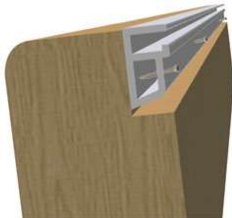
Figura 18 – Instalación de la guía de enganche
