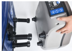
3) Desenrosca los tres conectores que están al nivel del bloque motor.
