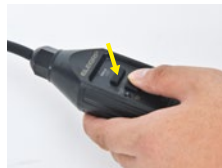
3. Drücken Sie die Test-Taste, die Anzeige erlischt.
