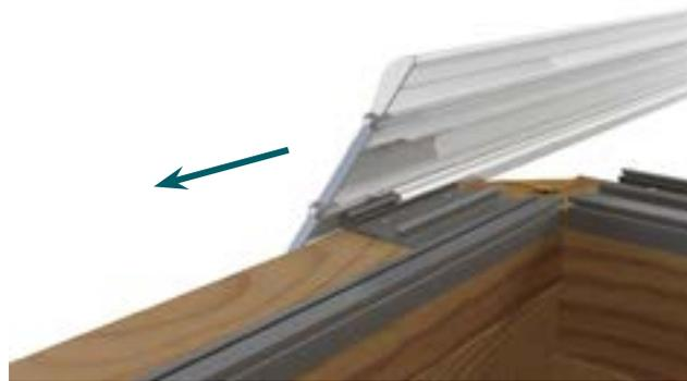
Atornille las zapatas de centrado del coronamiento (402) en su sitio, insertando un tornillo de cabeza redonda 4,2 x 9,5 (110) en la ranura de cada zapata para evitar que el coronamiento se deslice de lado a lado. Para hacer esto:
