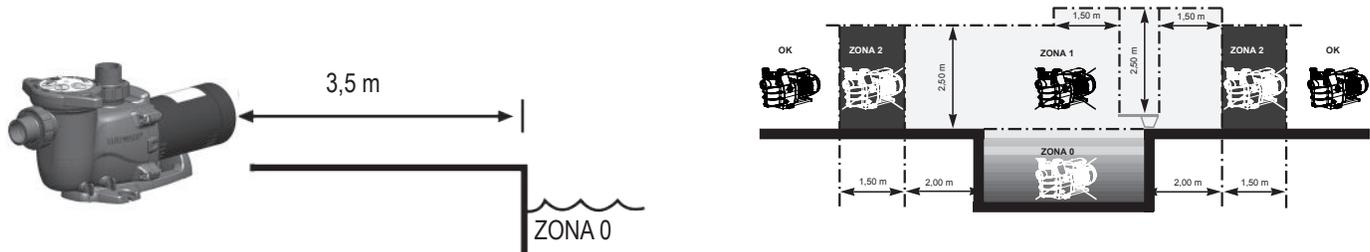
Instalar la bomba en un local ventilado y seco, el motor exige que el aire circule libremente alrededor de la bomba para que se ventile naturalmente. Comprobar regularmente que no haya objetos, hojas o cualquier otro obstáculo que pudiese obstruir la refrigeración del motor.
