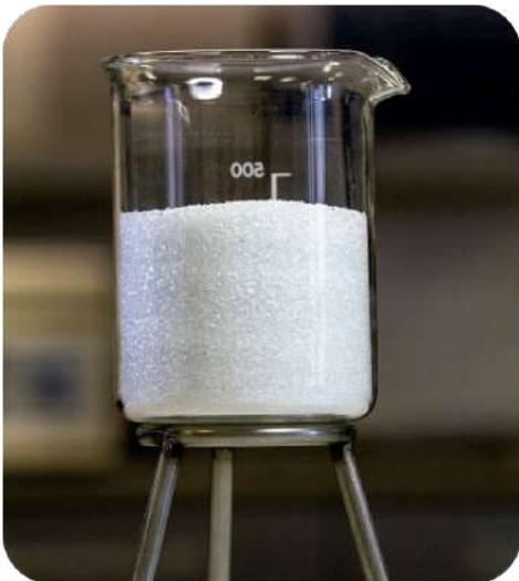
Hi-TECH sólo necesita una capa, con un solo tamaño de grano, para ofrecer un rendimiento máximo, a diferencia de otros medios filtrantes que requieren múltiples capas de diferentes granos para ser eficaces
