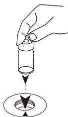
Colocar el estándar de referencia para el método correspondiente en el compartimiento de medición. ¡Debe tenerse en cuenta el posicionamiento!.
