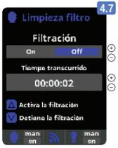
Desde cualquier Modo de Filtración accedemos a la pantalla "Limpieza de Filtro". Una vez seleccionada esta función, pulse la tecla OK.
