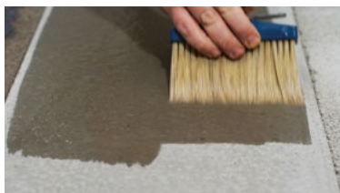
HORMIGÓN comprobación absorción
