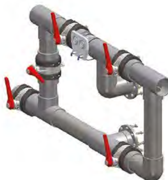
Baterías desmontadas con válvulas sistema Netvitic®
