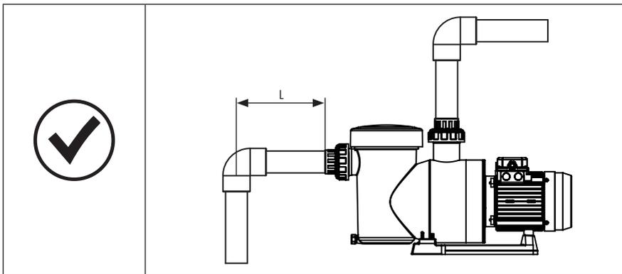
Longitud tubería aspiración (L) = 4 x Ø
