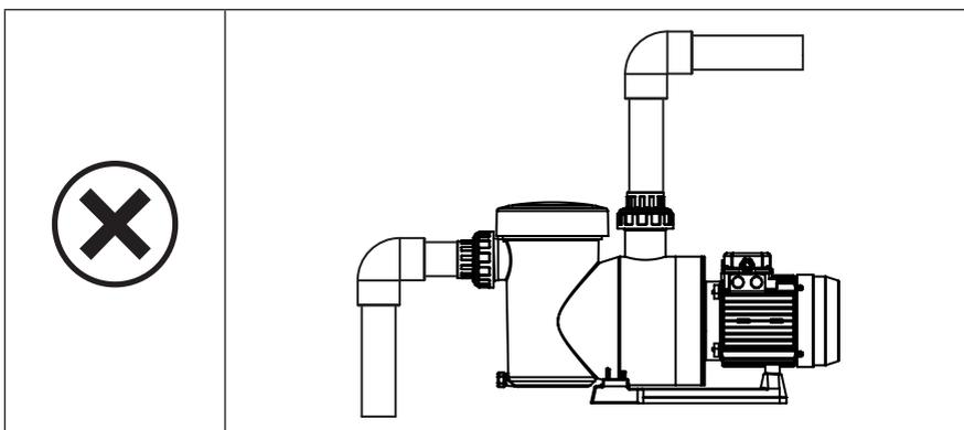
Tubería de aspiración muy corta. Riesgo de cavitación
